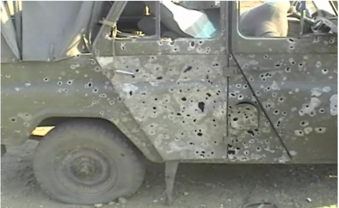
Фото. 3. Следы от воздействия осколочной боевой части направленного поражения
